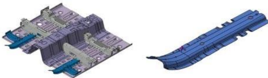
그림 1 1.5GPa 급 센터플로어 어퍼 멤버 형상
